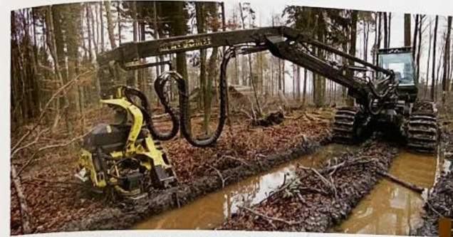
Verdichtung und Verformung des Bodens durch Einwirkung des Gesamtgewichtes. Strukturverformung und Absenkung der oberen Schichten bis zu 20 cm.
